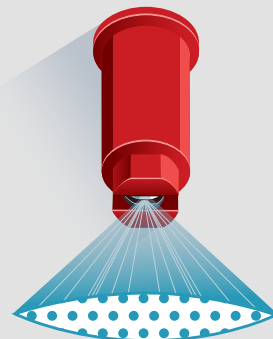
Chorro con inducción de aire "Venturi I"
