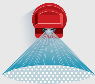
Jato plano de baixa deriva com pré-orifício
